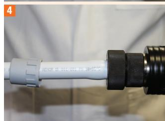
Avviare il processo di lavorazione fino alla completa formazione del bicchiere (lo sganciamento del tubo avverrà automaticamente).
